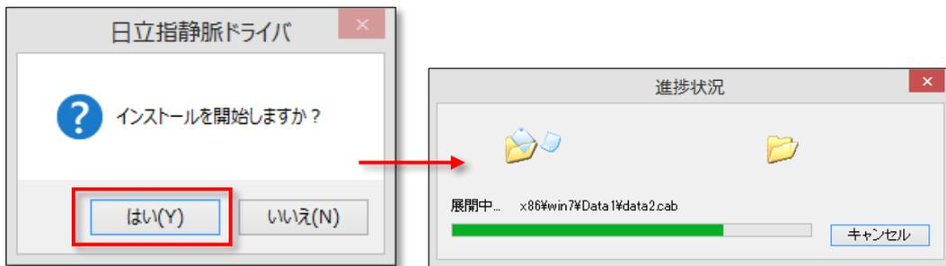
3. 進捗状況の表示が消えたら、指静脈リーダーを接続してください。リーダー上部のランプが点灯したら、インストールは完了しています。
